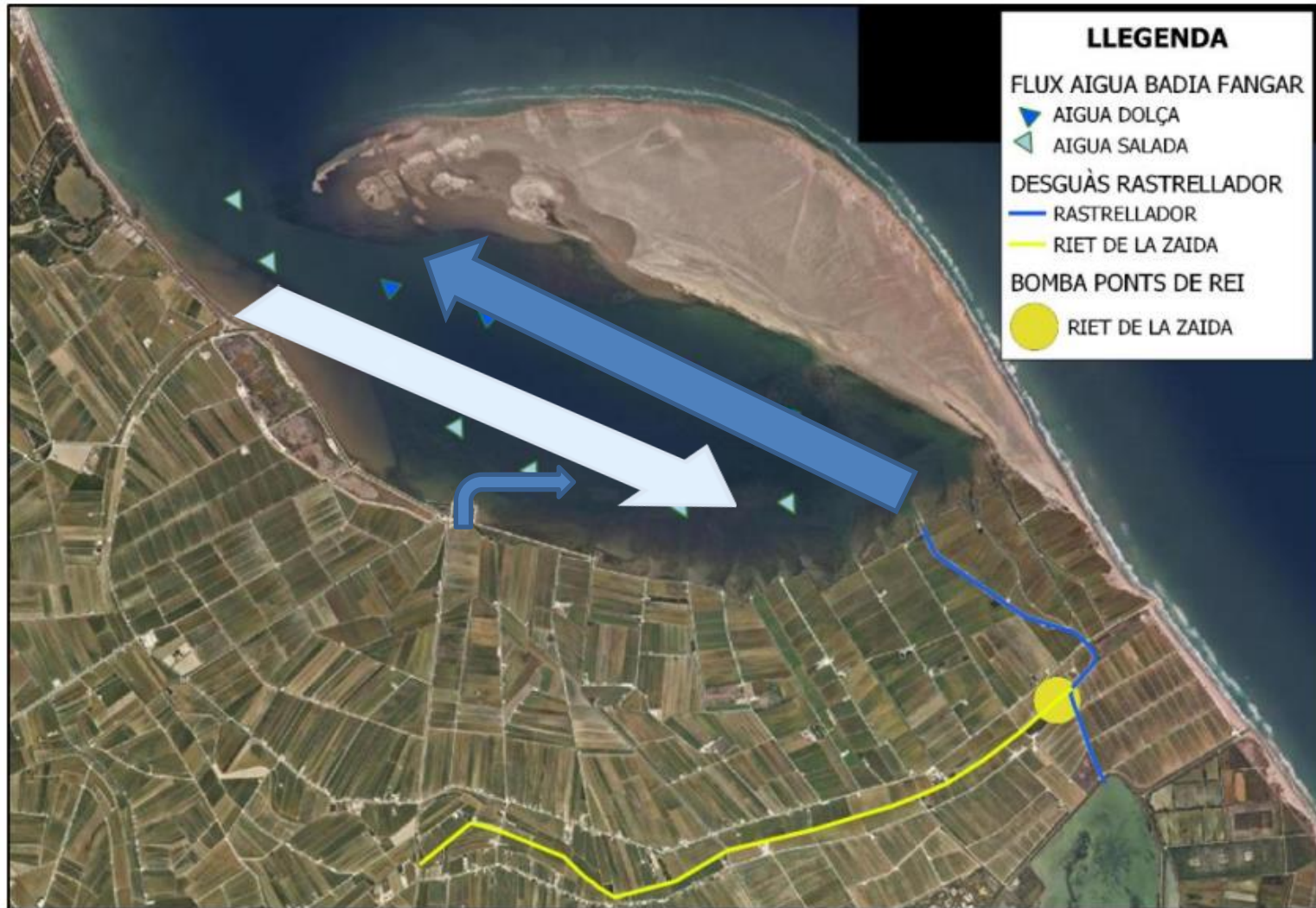
Imatge 12: Flux circular dintre de la badia del Fangar al instal·lar el bombeig Riet de la Zaida
